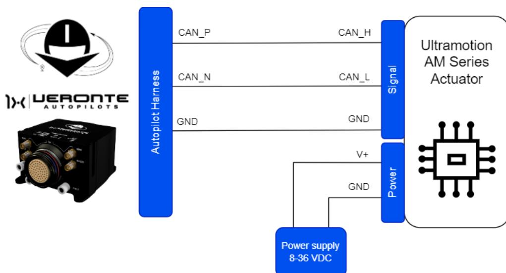
**Ultra Motion - Autopilot 1x wiring diagram**
