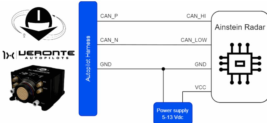
**Ainstein CAN Radar - Autopilot 1x wiring diagram**
