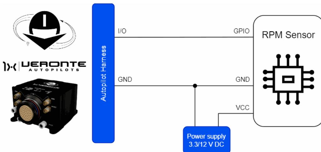
**RPM Sensors - Autopilot 1x wiring diagram**
