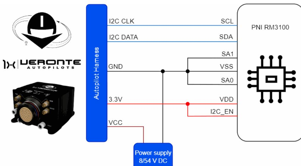
**PNI RM3100-CB - Autopilot 1x wiring diagram**
